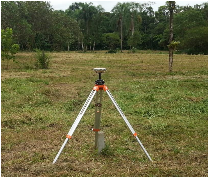
FIGURA 06– EQUIPAMENTOS MÉTODO RELATIVO ESTÁTICO FONTE: O AUTOR
