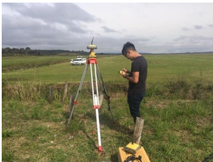
FIGURA 8 - IMPLANTAÇÃO DA BASE
