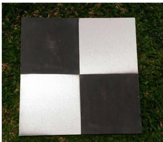
FIGURA 11 - MATERIALIZAÇÃO DO PONTO DE APOIO
